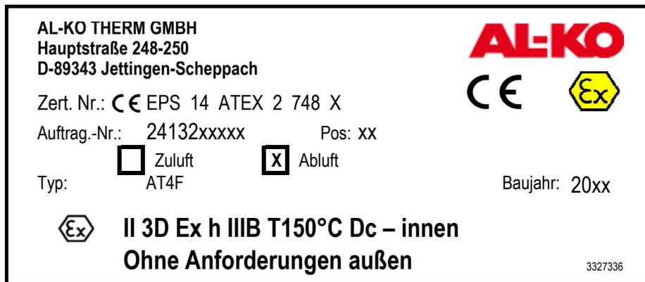
Fig. 8 Plaque signalétique ATEX zone 22 intérieur/sans exigence extérieure
