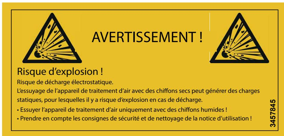
Fig. 2 Avertissement relatif aux décharges électrostatiques
