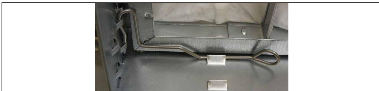
Fig. 77 Cadre de montage du filtre avec pince pour filtre gauche
