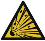
Risque d'explosion dû à des étincelles électriques ou à une charge électrostatique. Si des composants non autorisés pour le marquage ATEX et pour la zone ATEX sont utilisés, l'appareil peut se charger électrostatiquement. Des étincelles électriques peuvent entraîner une explosion.
