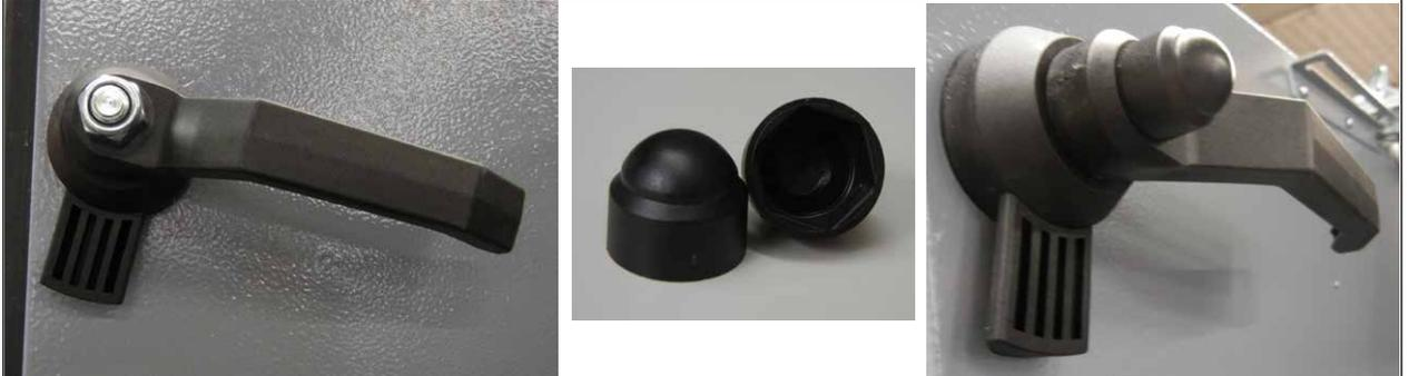
Fig. 19 Doter les axes des leviers à main de clapets de fermeture
