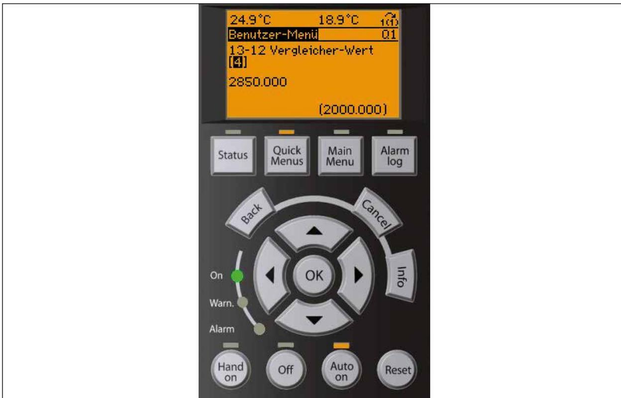
Fig. 24 Exemple d'affichage du paramètre 13-12 [4] : vitesse maximale de la pompe 2.850 tr/min (pré-réglé en usine)
