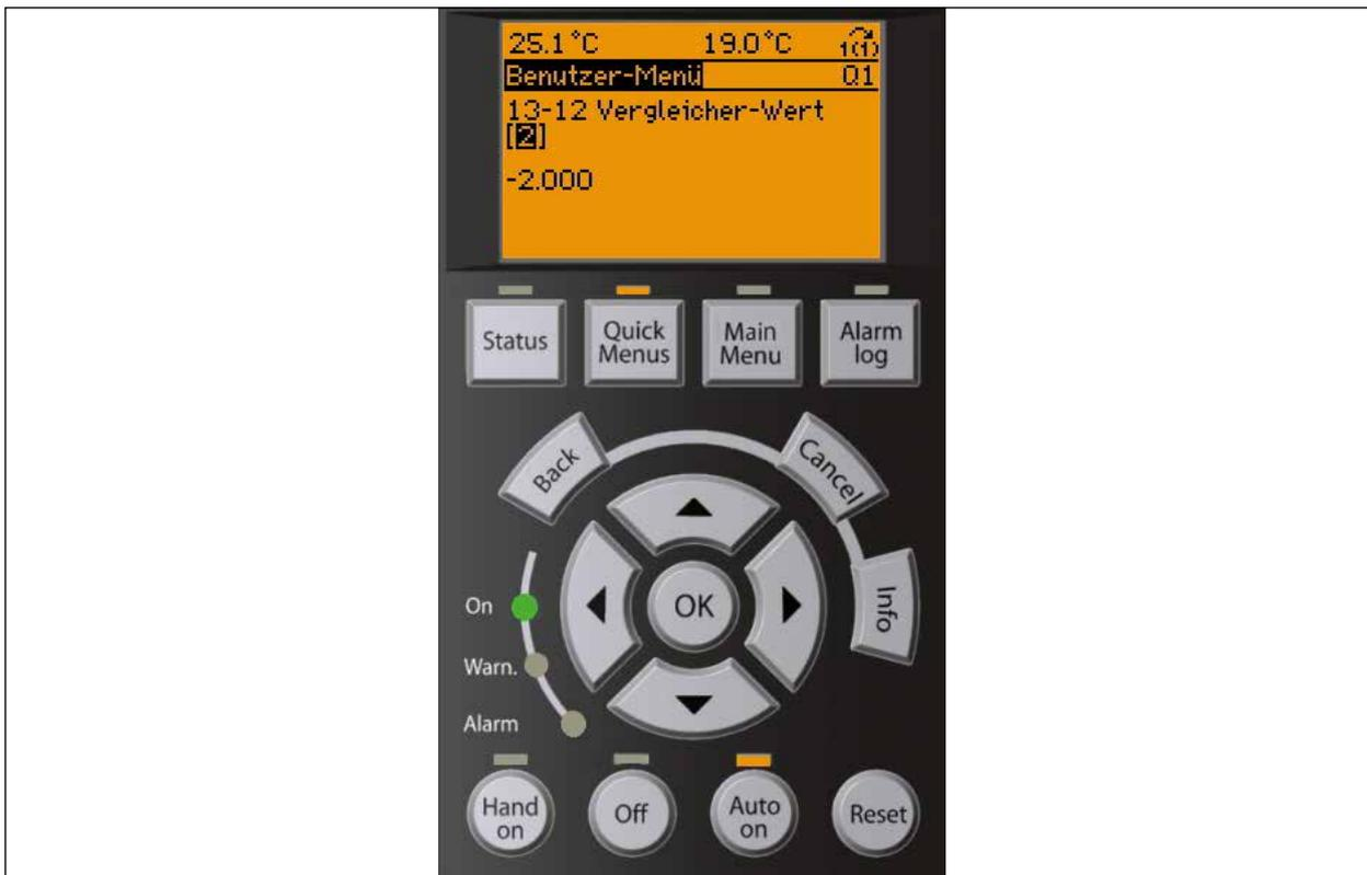
Fig. 25 Exemple d'affichage du paramètre 13-12 [2] : activation de la protection contre le givrage (pré-réglé en usine sur -8 °C)
