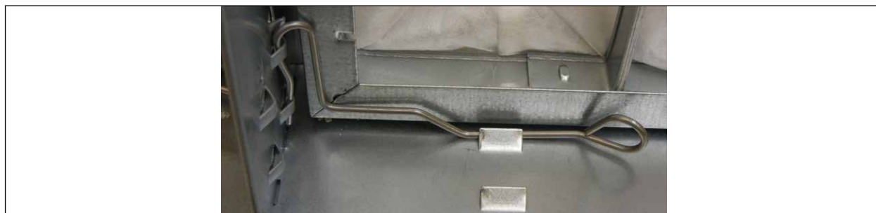
Rys. 68 Ramka mocująca filtra, klamra filtra po lewej
