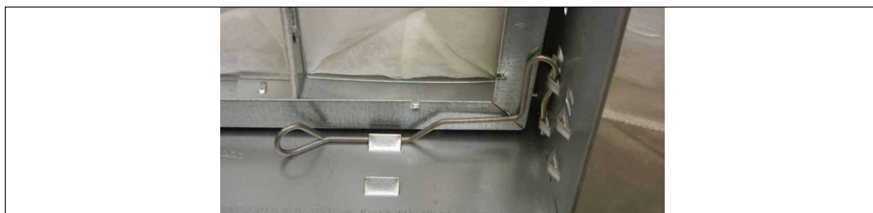
Rys. 69 Ramka mocująca filtra, klamra filtra po prawej
