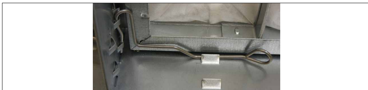
Fig. 68 Cadru suport filtru pentru clemă filtru stânga
