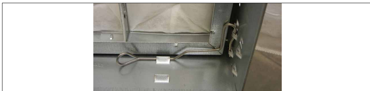
Fig. 69 Cadru suport filtru pentru clemă filtru dreapta
