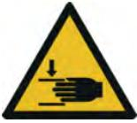
**Gefahr von Handverletzungen durch Quetschung beim Einstellen der korrekten Höhe an den Gerätefüßen.**
