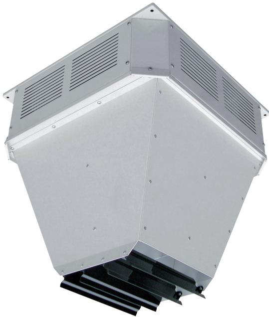
Der AL-KO Deckenlüfter „Energie“ fördert die Stauwärme unterhalb der Decke sowie die auftriebende Warmluft in die Aufenthaltszone zurück. Er wird in hohen beheizten Räumen eingesetzt, z.B. in Lager- und Speditionshallen, kombiniert mit den AL-KO Luftheizgeräten.
