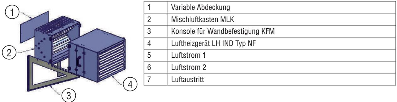
Abb. 28 Mischluftkasten
