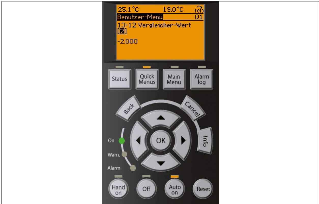
Abb. 25 Beispiel-Displayansicht Parameter 13-12 [2]: Aktivierung Bereifungsschutz (-8°C werksseitig voreingestellt)
