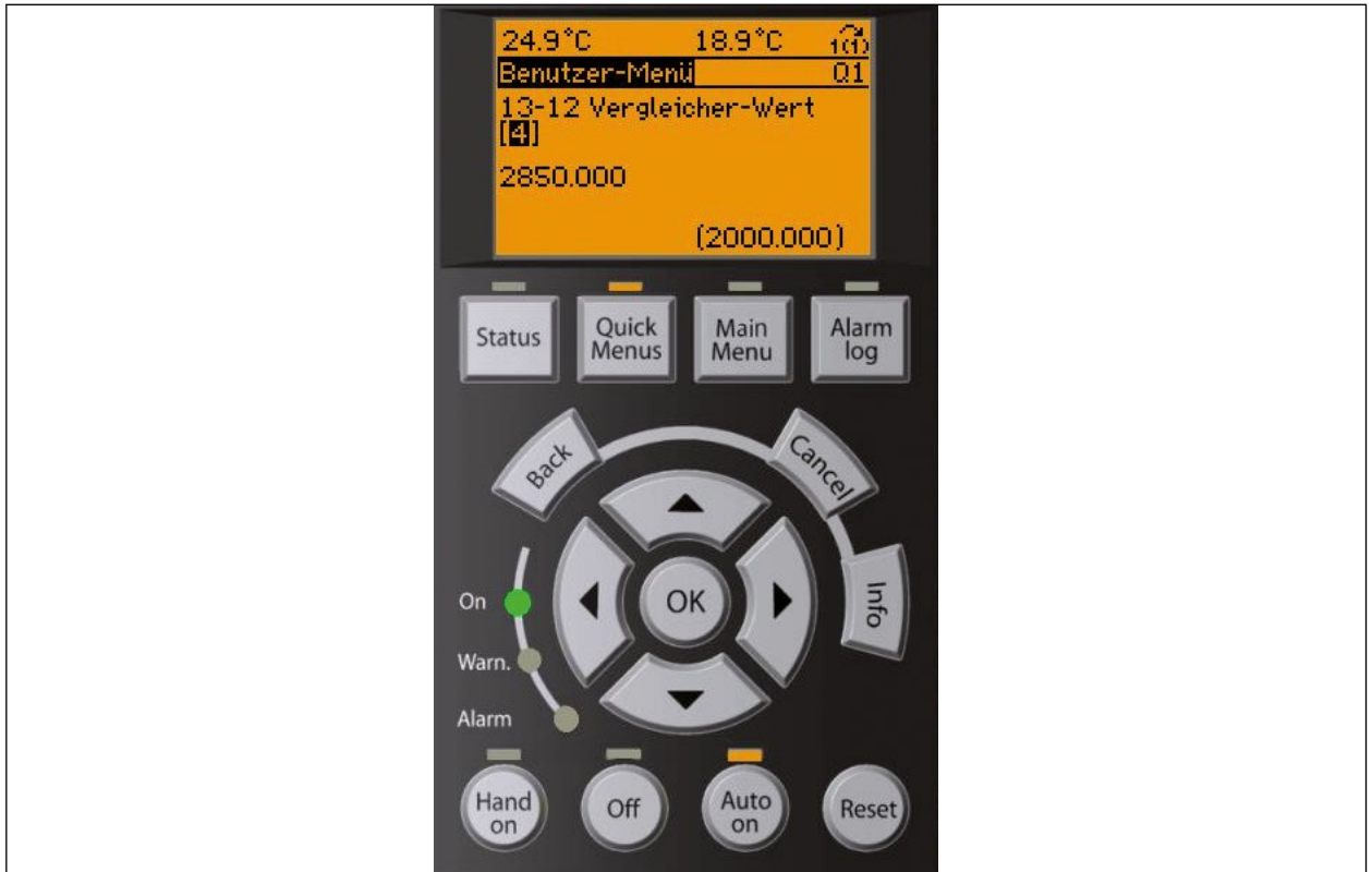
Abb. 24 Beispiel-Displayansicht Parameter 13-12 [4]: maximale Pumpendrehzahl 2850 min -1 (werksseitig voreingestellt)
