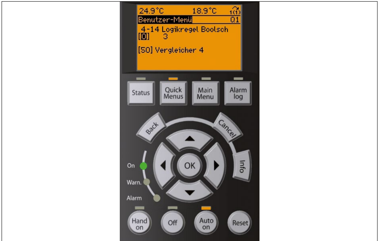
Abb. 26 Beispiel Parameter 4-14: Einstellen der erforderlichen Durchflussmenge (Angabe in Hz)
