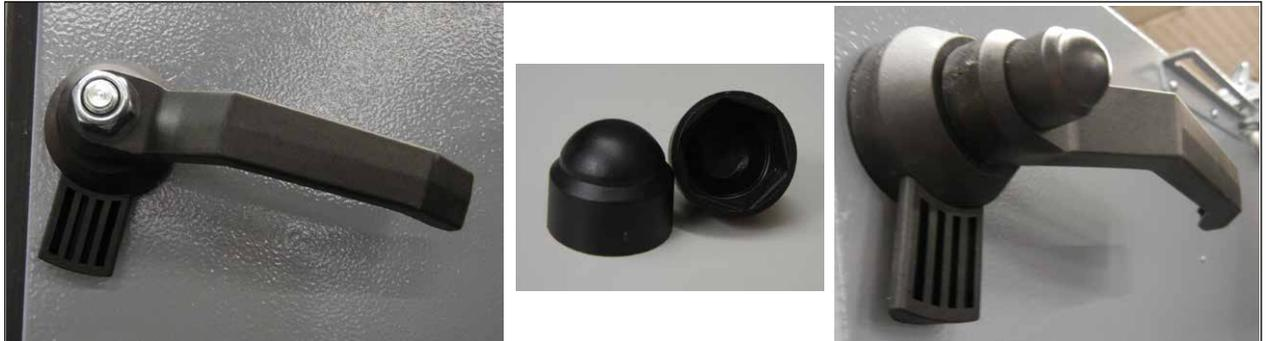
Abb. 19 Achsen der Handhebel mit Abdeckkappen versehen
