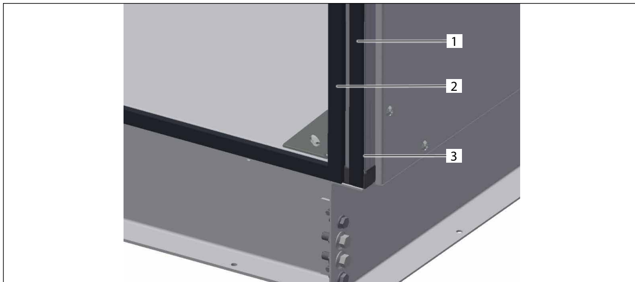
Afb. 8 Afdichting scheidingspunt bij plaatsing buiten
