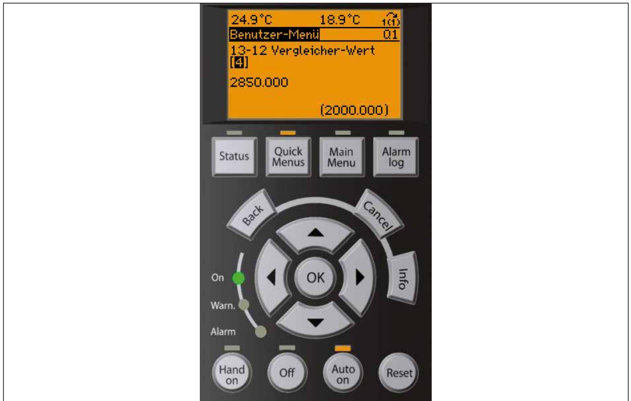
Abb. 24 Beispiel-Displayansicht Parameter 13-12 [4]: maximale Pumpendrehzahl 2850 min -1 (werksseitig voreingestellt)
