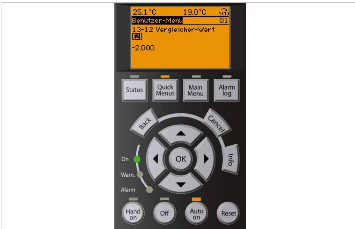
Abb. 25 Beispiel-Displayansicht Parameter 13-12 [2]: Aktivierung Bereifungsschutz (-8°C werksseitig voreingestellt)
