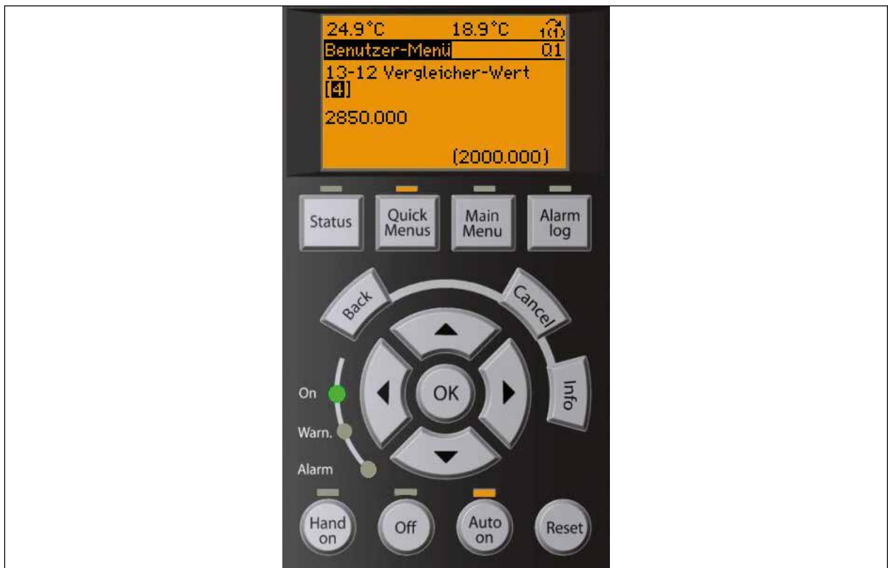
Afb. 24 Voorbeeld van display-aanzicht parameter 13-12 [4]: maximaal pomptoeental 2850 min-1 (in de fabriek voor ingesteld)
