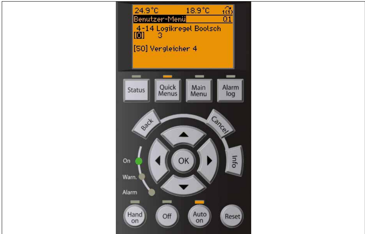
Afb. 26 Voorbeeld parameter 4-14: instellen van het noodzakelijke doorstroomvolume (opgave in Hz)
