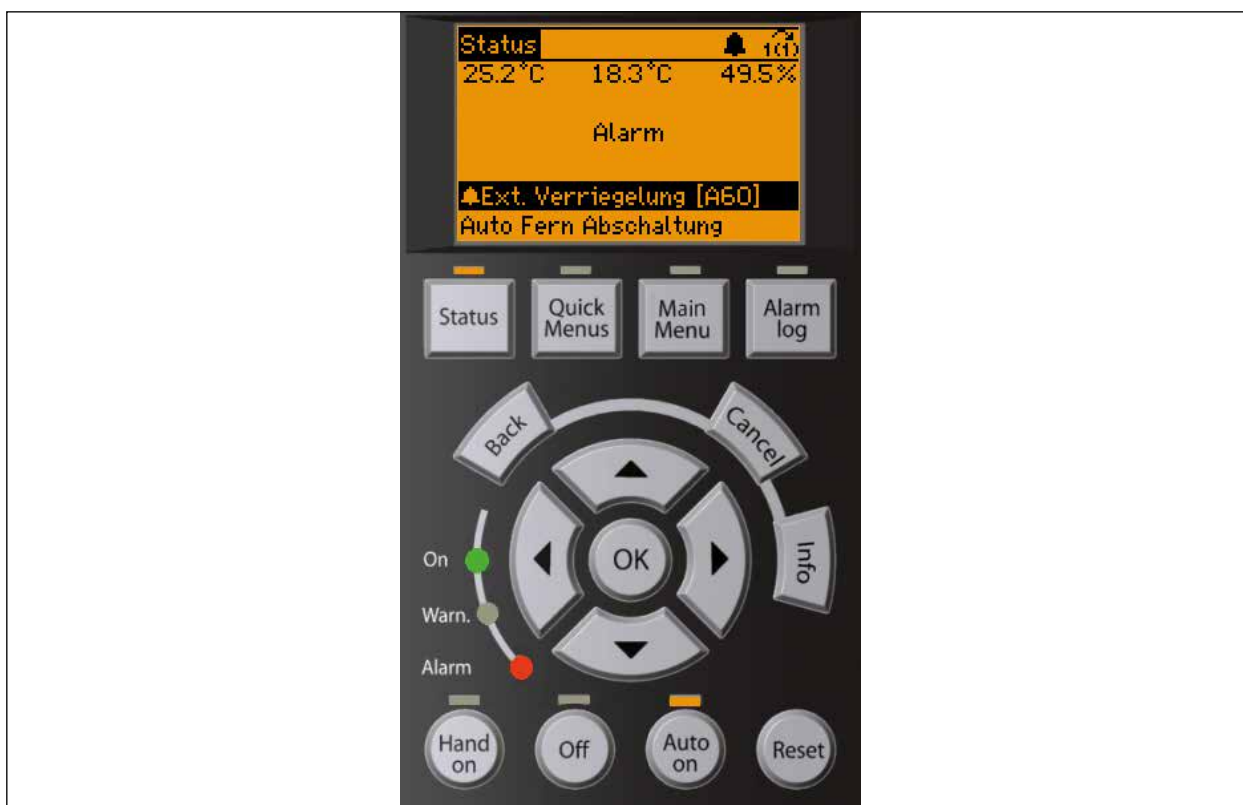
Afb. 23 Display-aanzicht bij functiestoring
